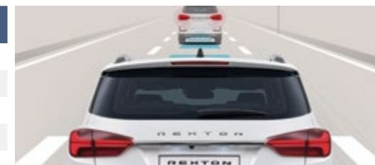
ESS – automatyczne włączanie świateł awaryjnych
